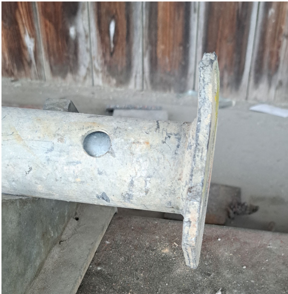
Abbildung 14: Unzulässige Verbiegung der Fußplatte
