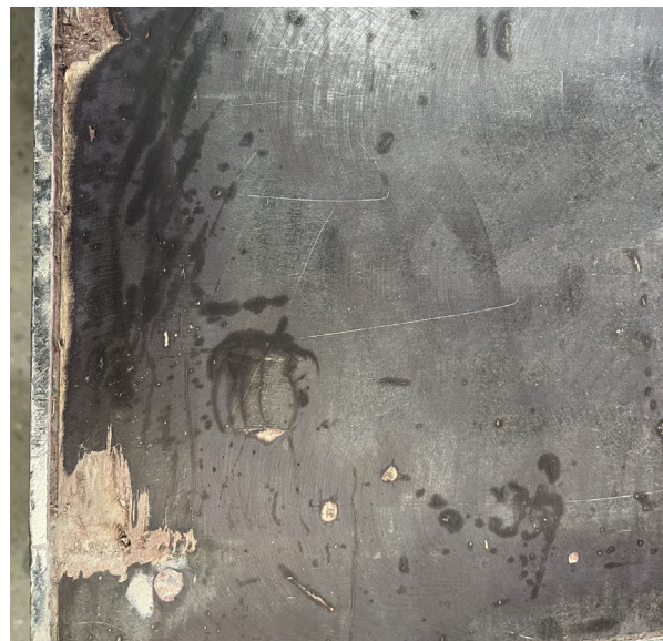
Abbildung 3: Unzulässige Beschädigungen in der Schalungshaut (Tiefe größer 1 mm, Deckfurnier durchdrungen)
