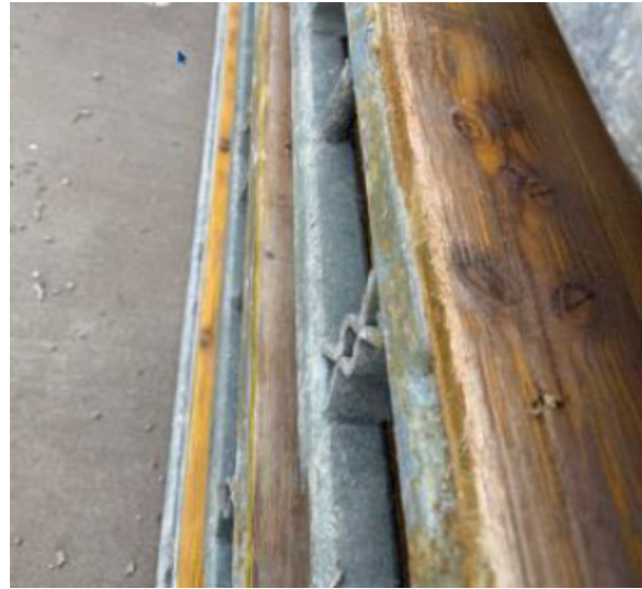
Abbildung 7: Zulässige Beschädigungen an der Schalungshaut
