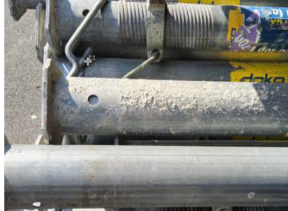
Abbildung 11: Unzulässig große Betonkrusten
