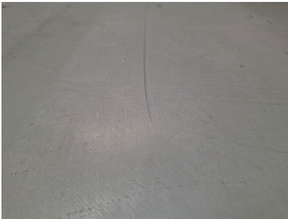
Abbildung 19: Unzulässiger Kratzer in der Schalungshaut (Tiefe > 1 mm)
