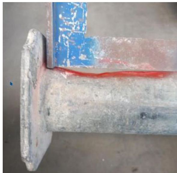
Abbildung 12: Unzulässige Delle am Außenrohr
